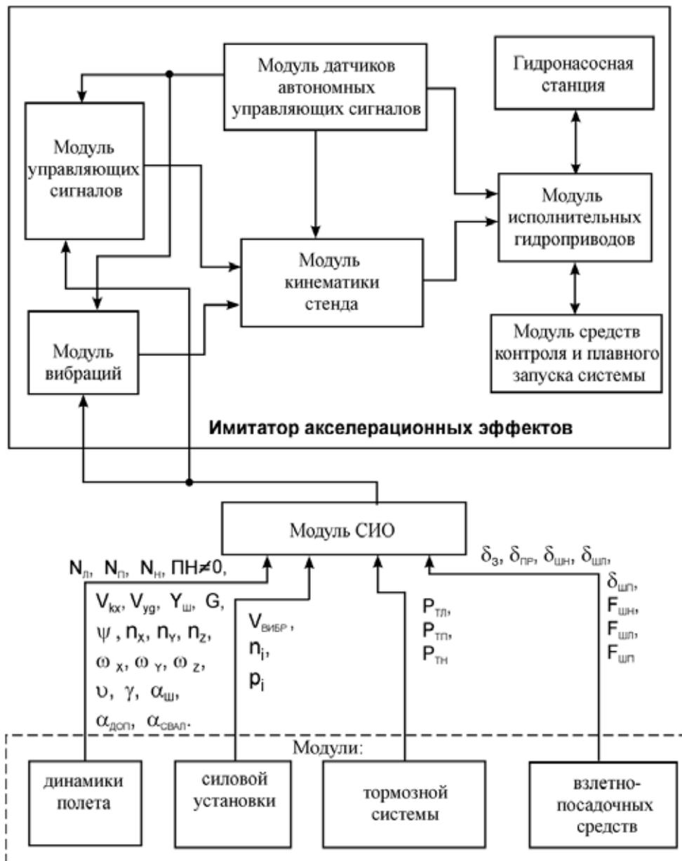
Рис. 5. Структурная схема модуля имитатора акселерационных эффектов
