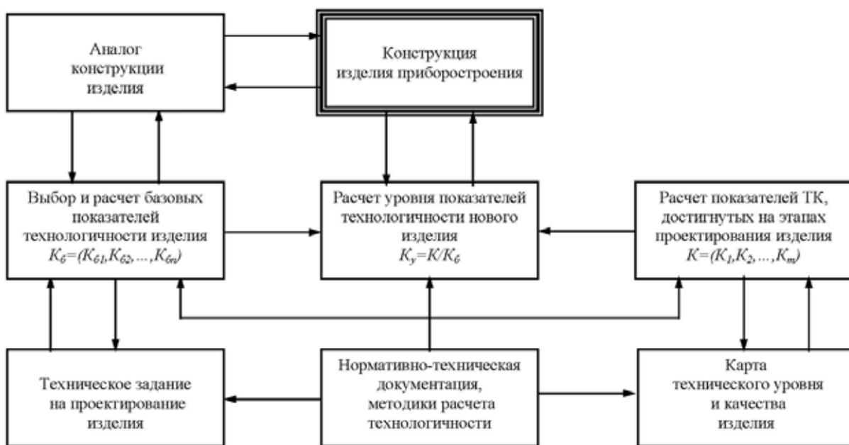
Рис. 1. Схема количественной оценки технологичности изделия приборостроения
